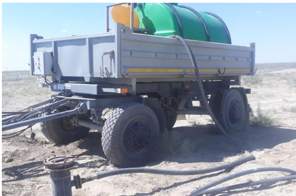
Рисунок 29 – Оборудование передвижного узла приготовления и подачи декольматирующих растворов в скважины
