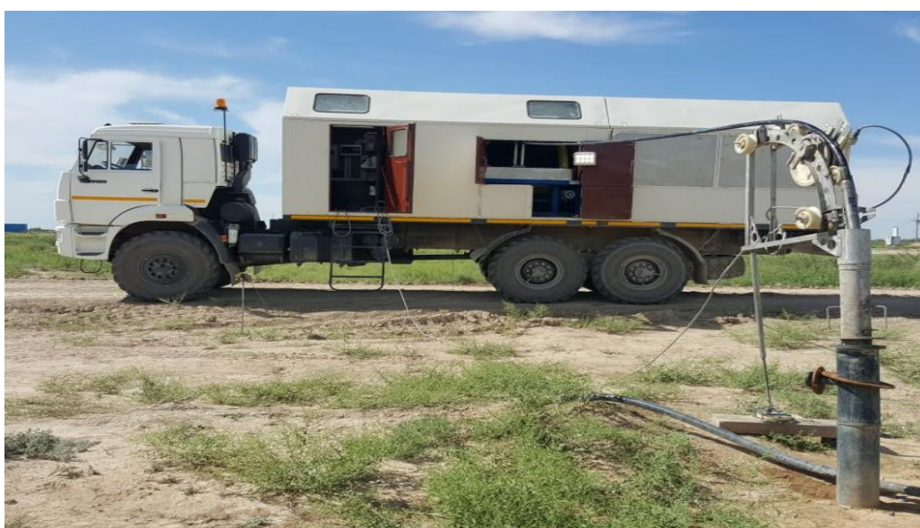
Рисунок 42 – Разработанное технологическое оборудование для повышения фильтрационных характеристик руд с применением разработанных составов
